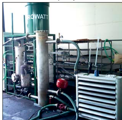
3. ábra A kísérleti PYROWATT berendezés kiviteli példája
