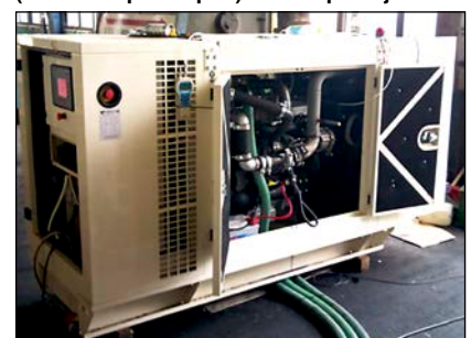
4. ábra A fagáz gázmotor (40 kWe – prototípus) kiviteli példája
